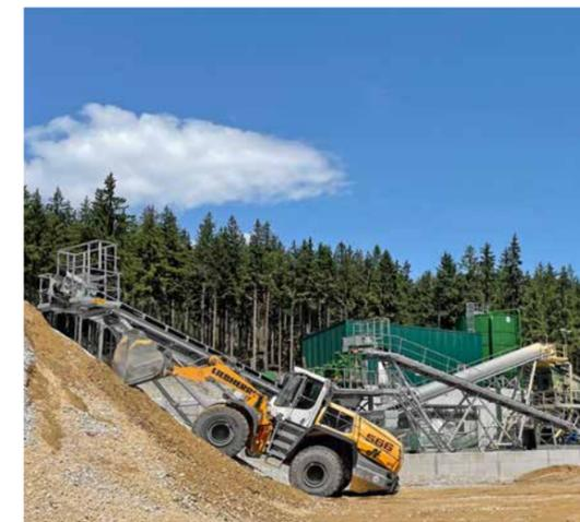
Moderne Maschinen, wie z. B. Radlader mit eingebautem Wiegesystem, sind Teil des effizienten Kiesabbaus in Ampflwang.
